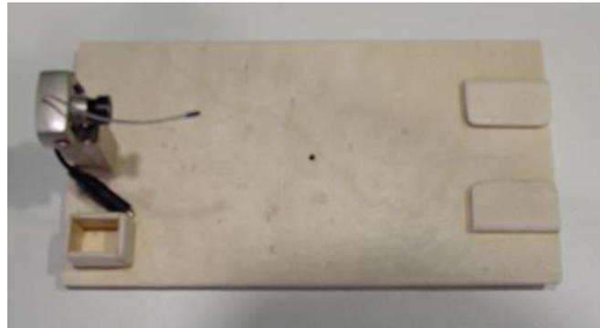
3. Die Kamerahalterung (5) mittig und in etwa 1 cm von der Rückseite der Experimentierplattform entfernt gegenüber den Experimenthalterungen aufkleben. **Achtung:** auf gute Klebeverbindung achten!
