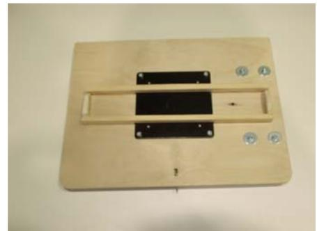
8. Die Halterung für den Elektromagneten wird aus zwei 20x20 mm Kieferleisten hergestellt. In diese wird mittig jeweils eine halbkreisförmige Aussparung geraspelt beziehungsweise gefeilt, so dass der Elektromagnet saugend in die zusammengesetzte Halterung passt. Alternativ kann man die Kieferleisten auch zusammenkleben und mit einem entsprechend großen Kernlochbohrer die Aufnahme für den Elektromagneten nachträglich herausbohren.
