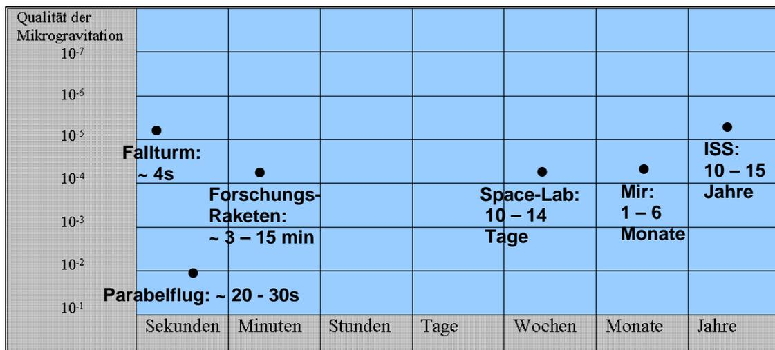
Abbildung 5: Möglichkeiten der Erzeugung von Mikrogravitation
